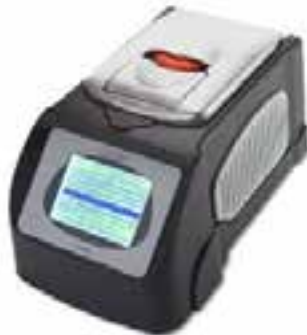
الشكل (1) أحد النماذج الشائعة لجهاز الـ PCR (جهاز تدوير حراري : thermal cyclers PCR apparatus).
